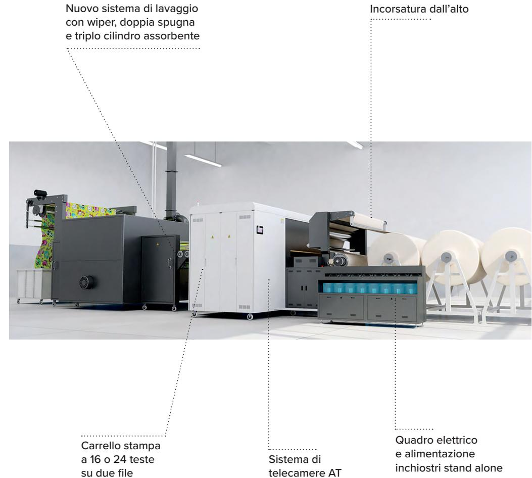
Nuovo sistema di lavaggio con wiper, doppia spugna e triplo cilindro assorbente
